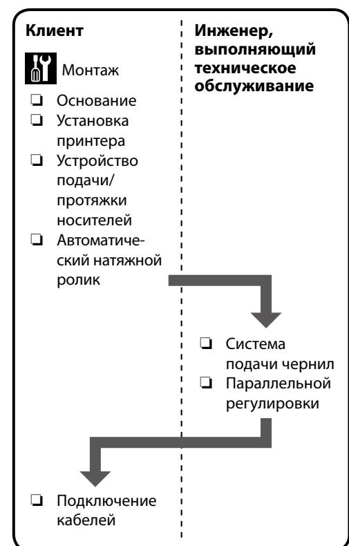
Після звернення до інженера-налагодника на принтер встановлюється Система постачання чорнил і шляхом виконання Паралельне налаштування регулюється Auto Take-up Reel Unit (Автоматичний приймач рулонних носіїв). Самостійне виконання цих процедур може привести до виходу приладу із ладу або до збоїв у його роботі; зверніть увагу, що компанія Epson не несе жодної відповідальності за такі виходи із ладу та збої.
