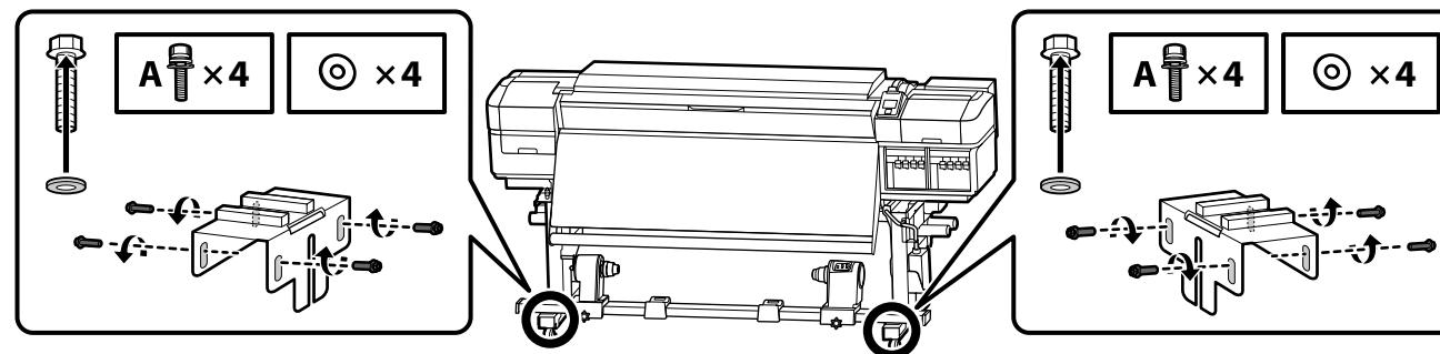
Brug de otte skruer som vist til venstre til at holde enheden på plads midlertidigt, indtil parallel justering er gennemført.
