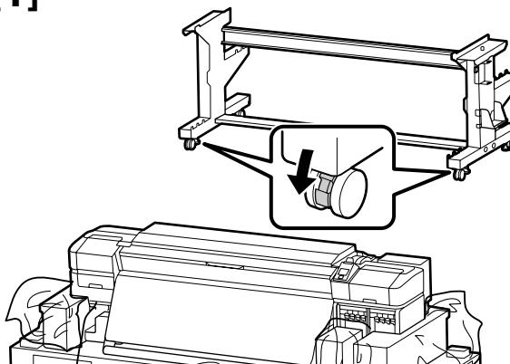
Før anvendelse af printeren skal du sikre dig, at stativet står rigtigt fast. Lås hjulene op, når du flytter printeren.
