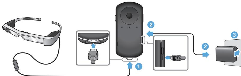
Quando la batteria è carica almeno al 90%, l'indicatore LED smette di lampeggiare e rimane acceso. L'indicatore LED si spegne quando la batteria è completamente carica. (L'indicatore LED fornisce un'indicazione di massima del livello residuo della batteria.)
