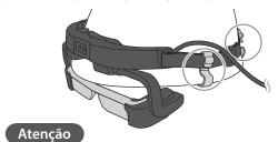
Instale os suportes para capacete em posições que não danifiquem o material de proteção dentro do capacete.
