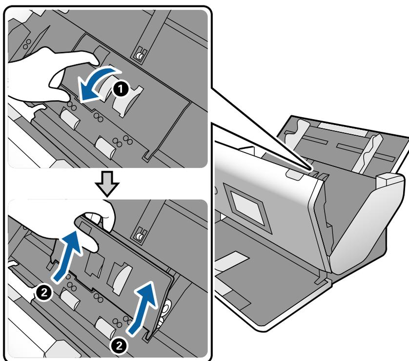
5. نگهدارنده محور غلتک را به سمت پایین بکشید و سپس غلتک بلندکننده نصب شده را بلغزانید و خارج نمایید.
