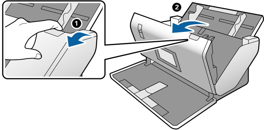
4. هرگونه لکه روی غلتک پلاستیکی و سطح شیشه‌ای قسمت داخلی و انتهایی قاب اسکنر را با استفاده از یک دستمال نرم یا کیت تمیزکاری اصلی Epson پاک کنید.
