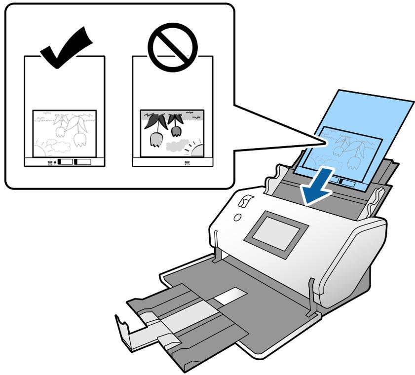
6. گیره‌های نگهدارنده لبه را با برگه حامل تنظیم کنید بدون اینکه فاصله‌ای در میان باقی بماند. در غیر این صورت ممکن است برگه حامل با خمیدگی وارد شود.
