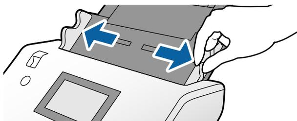
4. کارت‌ها را به نحوی بارگذاری کنید که سمت موردنظر آنها برای اسکن رو به پایین باشد و لبه جلویی به سمت ADF باشد. کارت‌ها را در ADF وارد کنید تا جایی که با مقاومت روبرو شوند.
