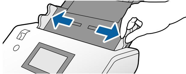
4. اسناد را در مرکز سینی ورودی و به ترتیب نزولی اندازه کاغذ قرار دهید طوری که عریض‌ترین‌ها در عقب و نازک‌ترین‌ها در جلو قرار گیرند.
