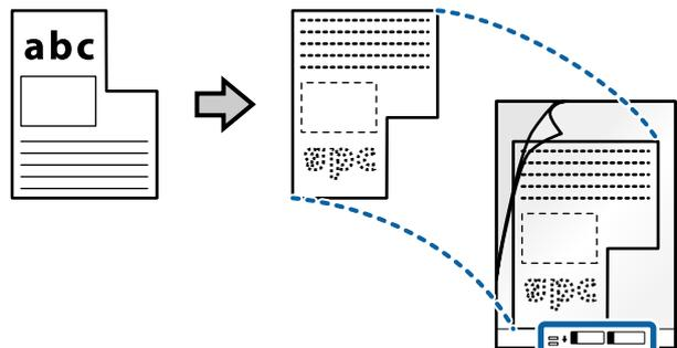
5. برگه حامل را به نحوی بارگذاری کنید که لبه جلویی آن رو به ADF باشد. آن را در ADF وارد کنید تا جایی که با مقاومت روبرو شود.
