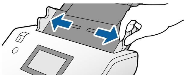
4. Assurez-vous que l'illustration au bord de la Feuille support est orientée vers l'avant, et que l'original est orienté vers l'arrière lorsque vous insérez l'original dans le Feuille support.
