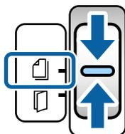
2. Déployez l'extension du bac d'insertion. Réglez sa longueur en fonction de celle de l'original. Relevez la butée si nécessaire.
