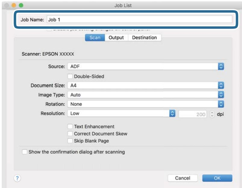
5. Spécifiez les paramètres de numérisation dans l'onglet **Scanner**.
