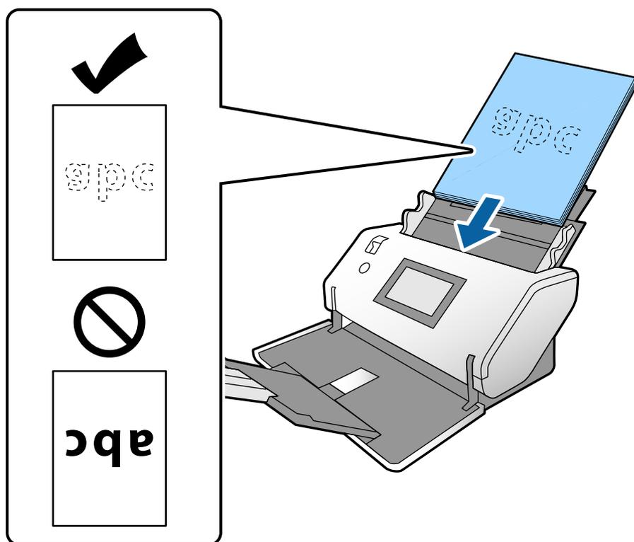
7. Ajustez les guides latéraux pour qu'ils s'ajustent aux originaux sans écart. Autrement, les originaux pourraient être insérés de travers.
