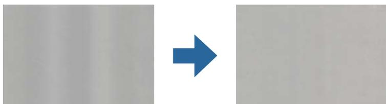
Si le scanner reçoit une lumière directe trop forte, telle que celle du soleil, le capteur interne du scanner ne détecte pas correctement la lumière et les couleurs de l'image numérisée deviennent inégales.
