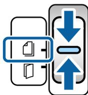
2. Déployez l'extension du bac d'insertion. Extrayez le bac de sortie, déployez son extension et relevez la butée.
