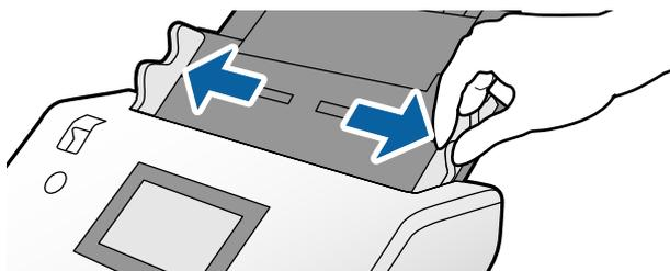
4. Chargez le livret dans le bac d'insertion avec la surface imprimée orientée vers le bas, et la face plus épaisse alignée avec la ligne du bord d'attaque, comme indiqué sur le diagramme.
