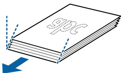
6. Chargez les originaux avec la face à numériser vers le bas et le bord d'attaque orienté vers l'ADF.
