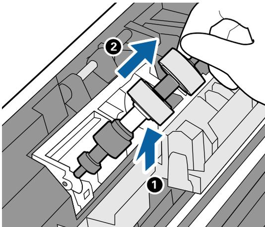
10. Insérez le nouvel axe de rouleau de séparation dans l'orifice et abaissez le rouleau.
