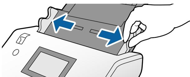
4. Chargez les enveloppes dans le sens de la longueur, face à numériser orientée vers le bas dans le bac d'alimentation. Dans le cas d'enveloppes avec une extrémité ouverte (partie battant) sur le côté plus court, chargez l'enveloppe avec le côté ouvert (rabat) placé vers le haut.
