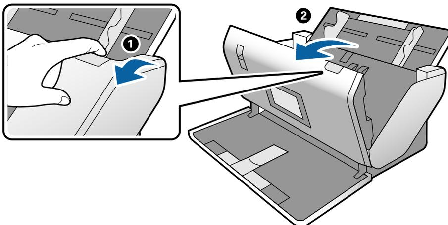
3. Retirez soigneusement les originaux encore présents à l'intérieur du scanner.
