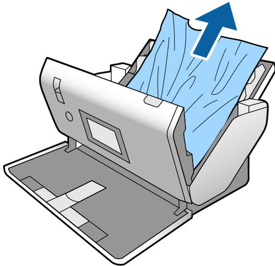
4. Si vous ne pouvez pas tirer les originaux vers le haut, tirez soigneusement les originaux coincés dans le bac de sortie dans le sens de la flèche.
