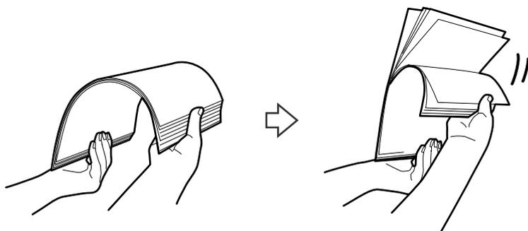
5. Alignez les bords des originaux avec la face à numériser vers le bas, et faites glisser le bord d'attaque en biseau.
