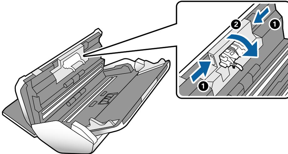
9. Soulevez l'extrémité gauche du Rouleau séparation, puis faites coulisser et retirez le Rouleau séparation installé.
