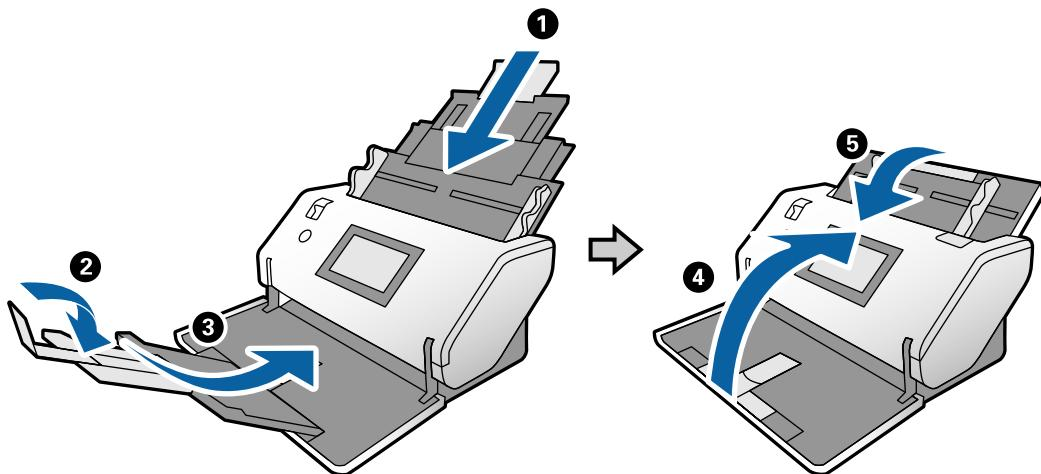
2. Pomerite birački preklopnik položaja sa zadnje strane skenera prema gore.
