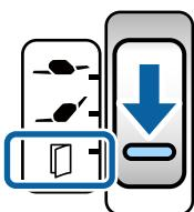
2. Izvucite produžetak izlaznog podmetača i podignite graničnik. Povucite nazad produžetak izlaznog podmetača tako da odgovara veličini brošure.
