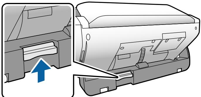
3. Dok držite birački preklopnik položaja podignutim, polako zaokrenite kućište skenera.
