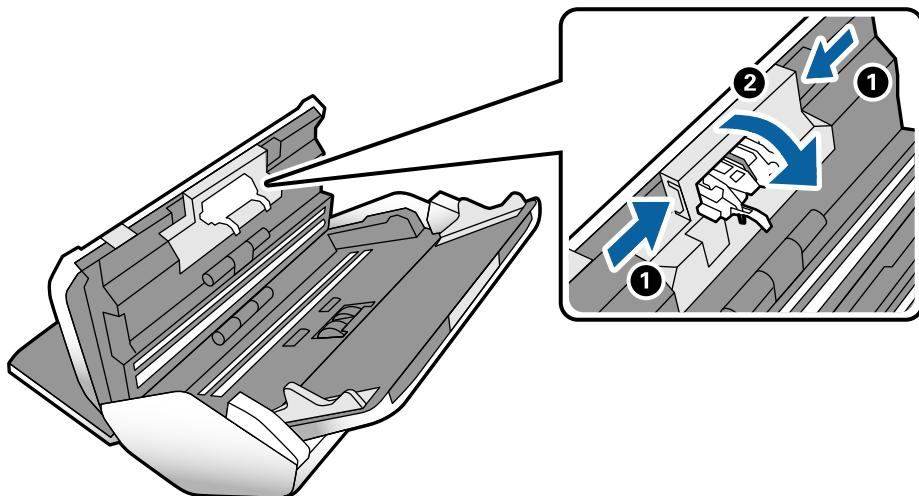
10. Podignite levu stranu Valjak za razdvajanje, a zatim gurnite i izvadite montirani Valjak za razdvajanje.
