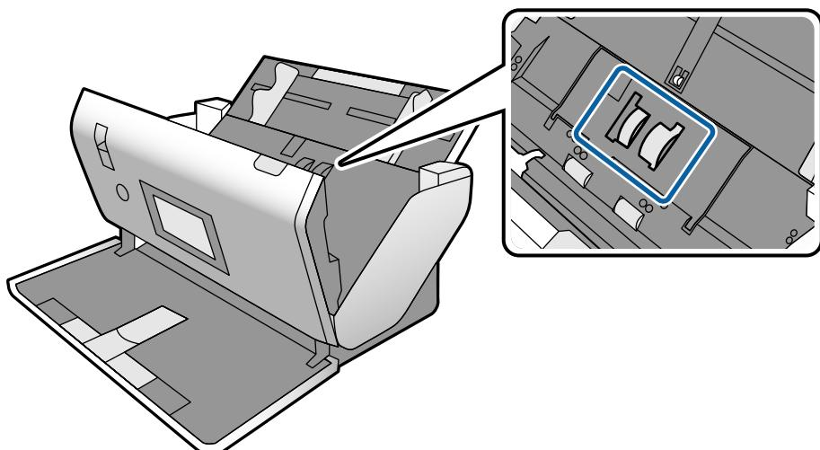
10. Obrišite prašinu ili nečistoće na Valjak za uvlačenje papira pomoću originalnog Epsonovog pribora za čišćenje ili meke, vlažne krpe.
