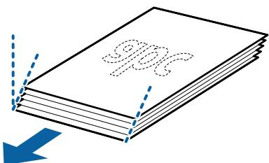
7. Ubacite originale sa stranom za skeniranje okrenutom prema dole i glavnim ivicom okrenutom prema ADF. Ubacujte papir u ADF sve dok ne naiđe na otpor.
