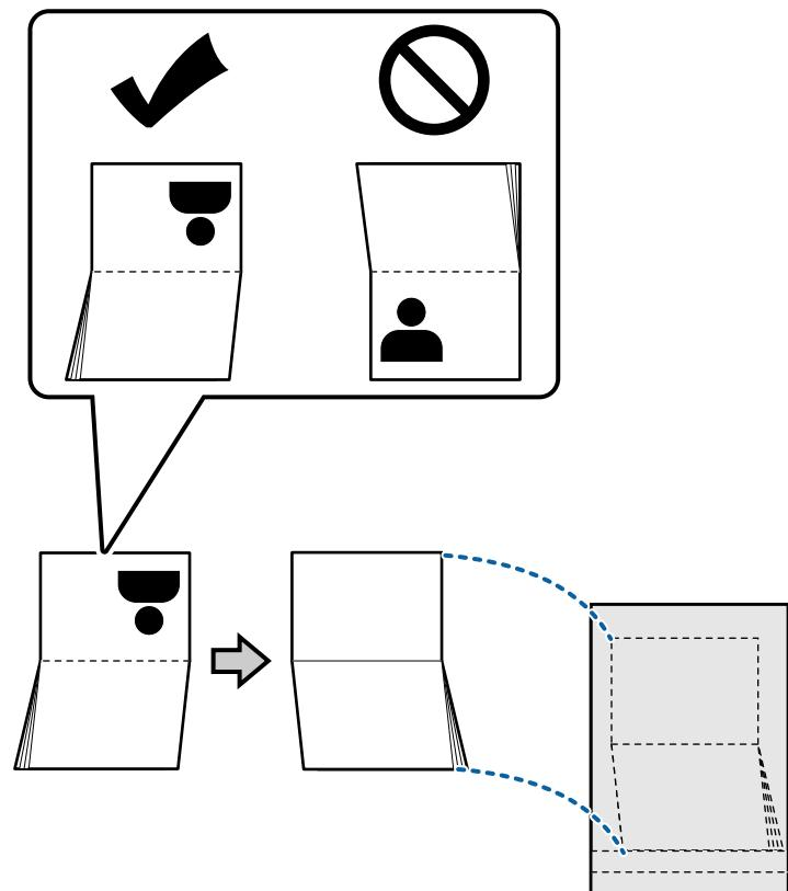
5. Ubacite ga u ulazni podmetač sa stranom za skeniranje okrenutom prema dole i stranom koja ima veći broj stranica okrenutom prema glavnoj ivici.
