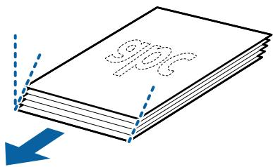
6. Ubacite originale sa stranom za skeniranje okrenutom prema dole i glavnom ivicom okrenutom prema ADF.
