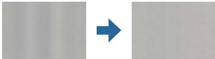
Ako je skener izložen jakom svetlu kao što je direktna sunčeva svetlost, senzori u skeneru pogrešno detektuju svetlo i boje na skeniranoj slici postaju nejednake.
