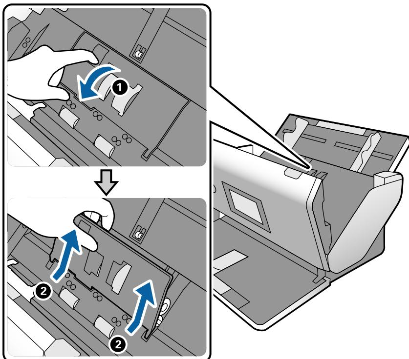
6. Pritisnite deo za učvršćivanje osovine valjka, a zatim gurnite i izvadite montirani Valjak za uvlačenje papira.
