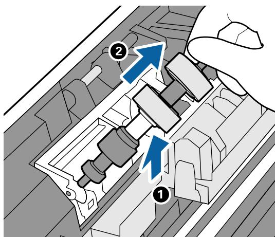
11. Ubacite osovinu novog valjka za razdvajanje u otvor, a zatim spustite valjak.
