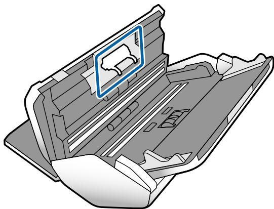
8. Obrišite prašinu ili nečistoće na Valjak za razdvajanje pomoću originalnog Epsonovog pribora za čišćenje ili meke, vlažne krpe.
