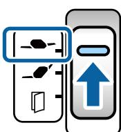
3. Izvucite produžetak ulaznog podmetača. Izvucite produžetak izlaznog podmetača prema dužini originala. Po potrebi podignite graničnik.
