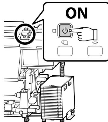
Úvodné nastavenie začína vtedy, keď sa tlačiareň zapne po prvýkrát. Zvoľte jazyk a pomocou pokynov na obrazovke nastavte čas a vyberte merné jednotky. Používatelia série SC-S80600L budú potom vyzvaní, aby si vybrali režim farby. Režim farby je možné zmeniť kedykoľvek, keď je už úvodné nastavenie dokončené; viac informácií nájdete v *Používateľská príručka* (PDF).
