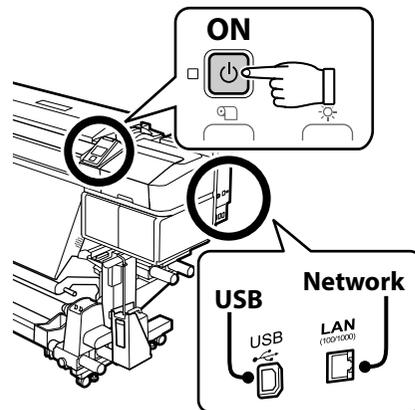
Pred pokračovaním pripravte tlačiareň a počítač na pripojenie, káble však nepripájajte, kým vás inštalátor k tomu nevyzve. Základný softvér sa nenainštaluje, ak zariadenia nebudú pripojené podľa pokynov na obrazovke.
