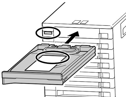
Po potvrdení, že sa farby štítkov na jednotke Ink Supply Unit (atramentovej doplnačej jednotke) a atramentovej jednotke zhodujú, zasuňte zásobník tak, aby sa dotýkal zadnej časti otvoru.
