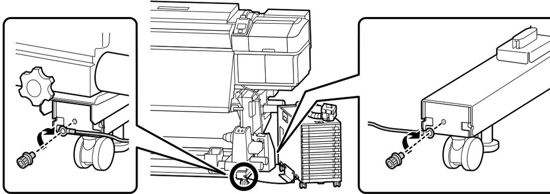
Zaistite upevňovací drôt na prednej a zadnej strane stojana tlačiarne pomocou skrutiek. Pokiaľ nie je atramentová jednotka zaistená zadržiacím drôtom, môže dôjsť k poškodeniu atramentovej trubice, ak sa atramentová jednotka pohybuje počas pripojenia.
