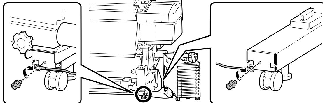
Sørg for at afsikre fastholdelsesledningen foran og bag på printerbenet med skruer. Hvis blækenheden ikke er afsikret med fastholdelsesledningen, kan blækrøret blive beskadiget, hvis blækenheden flyttes, mens blækenheden er tilsluttet.
