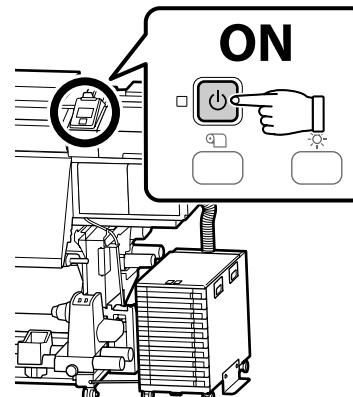
Den indledende opsætning starter, først gang der tændes for printeren. Vælg et sprog, og følg instruktionerne på skærmen for at indstille uret og vælge måleenheder. Brugere af SC-S80600-serien vil derefter blive bedt om at vælge en farvetilstand. Farvetilstanden kan ændres når som helst, når den indledende opsætning er fuldendt. For yderligere oplysninger henvises der *Brugervejledning* (PDF).
