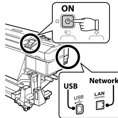
Klargør printeren og computeren til forbindelse før der fortsættes, men forbind ikke kablerne, før installationsguiden beder dig om at gøre det. Den grundlæggende software bliver ikke installeret, hvis enhederne ikke er forbundne ifølge instruktionerne på skærmen.
