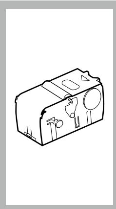
Hvis kontrolpanelet viser beskeden **Wiper Unit Out (Viskerenhet fra)**, skal man følge trinene forneden for at installere den vedlagte wiper unit (viskerenhet).
