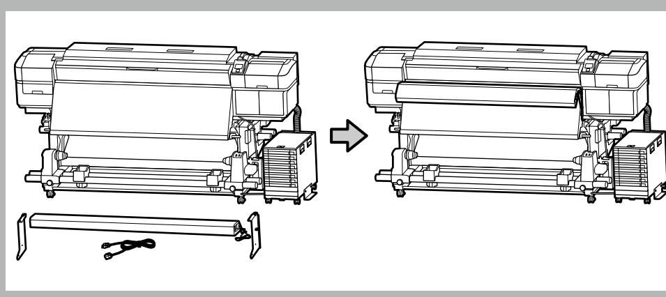
Installér det yderligere udskriftstørresystem\* som beskrevet i den brugervejledning, der leveres med systemet.
