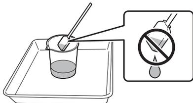
Quando si inumidisce uno strofinaccio con ink cleaner (kit solvente per inchiostro), utilizzare ink cleaner (kit solvente per inchiostro) versato in un contenitore.
