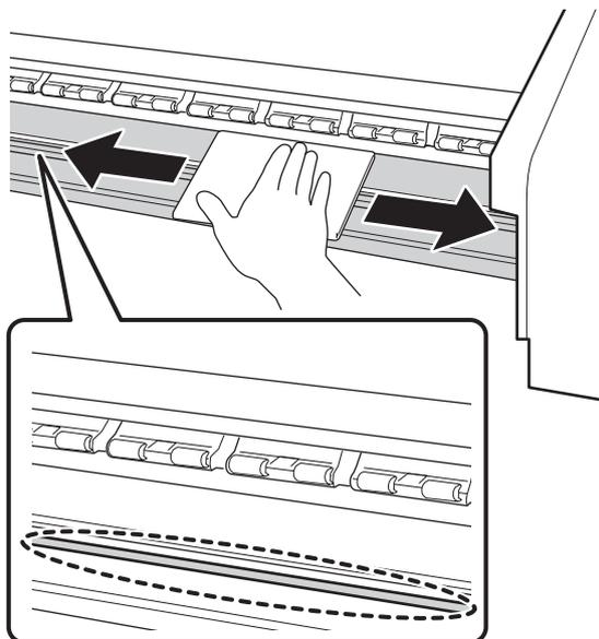
**5** Immergere un panno morbido in acqua, strizzarlo bene, ed eliminare filamenti o polvere sulle piastre laterali del supporto.
