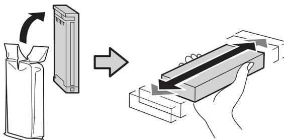
**5** Faça corresponder a cor do tinteiro com a cor da etiqueta existente na impressora e inserir.
