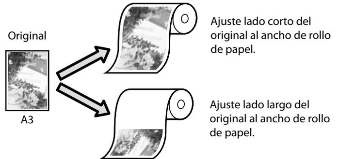
Seleccione **Output Size (Tamaño de salida) - Fit to Roll Paper Width (Ajustar al ancho del rollo de papel)** y, a continuación, seleccione si desea ajustar el lado corto o el lado largo del original al ancho de rollo de papel.
