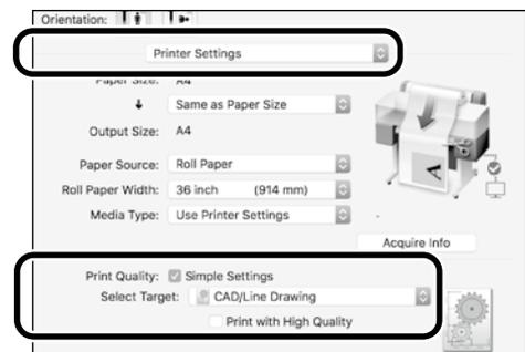
Imprima dibujos CAD y GIS utilizando uno de los dos métodos siguientes dependiendo del uso que pretenda dar al dibujo.
