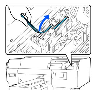
Prepare duas varas de limpeza finas novas e duas varas de limpeza largas novas, e humedeça-as com limpador de tinta.
