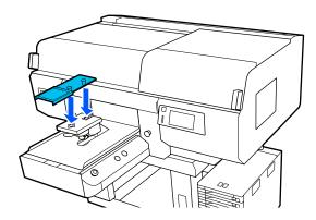
(2) Alinhe a banda de fixação com a ranhura na parte superior da superfície dentada e enrole.
