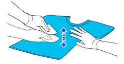
Colocar a T-shirt no pulverizador, aplicar o líquido de pré-tratamento de forma uniforme na superfície de impressão.
