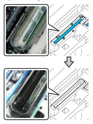
Qualquer sujidade em torno das extremidades pode originar uma diminuição no poder de sucção. Se restar alguma sujidade, humedeça a vara de limpeza com produto de limpeza de tinta e repita os passos 7 e 8 para remover a sujidade. Se a vara de limpeza estiver suja, substitua-a por uma nova.
