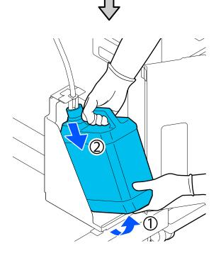
Insira o tubo de tinta residual no orifício do novo frasco de tinta residual e coloque o frasco de tinta residual no suporte.
