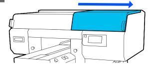
Abra o lado esquerdo da tampa da impressora e, em seguida, substitua os restantes 2 filtros de ar utilizando o mesmo procedimento que usou para o lado direito.
