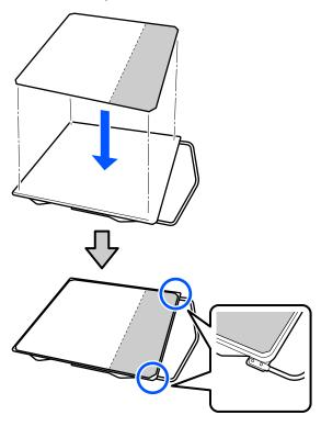
Pressione suavemente a secção a partir da qual a parte de trás foi arrancada da almofada de fixação para colar a almofada de fixação na bandeja.
