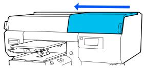
Segure no encaixe do filtro de ar e retire-o.
