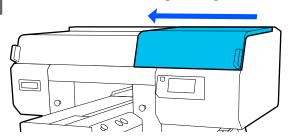
Segure as abas em ambos os lugares, e levante a unidade de limpeza para a remover.
