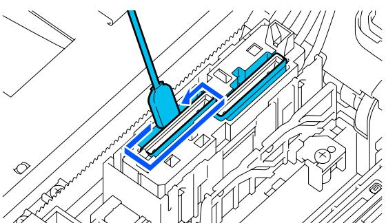
**8** Протирая внешнюю поверхность всасывающего колпачка, протрите также верхнюю кромку.
