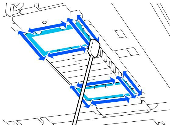
Если невозможно удалить пыль одним движением, смочите чистящую палочку чистящей жидкостью и повторите действия 12 и 13 для удаления грязи. Если в процессе очистки чистящая палочка загрязнилась, возьмите новую.
