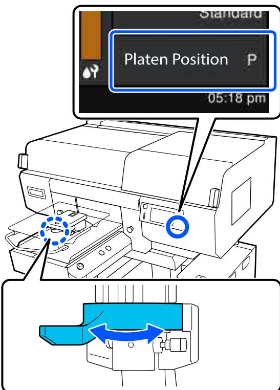
При повороте рычажка против часовой стрелки числа увеличиваются и высота расположения печатного стола уменьшается.
