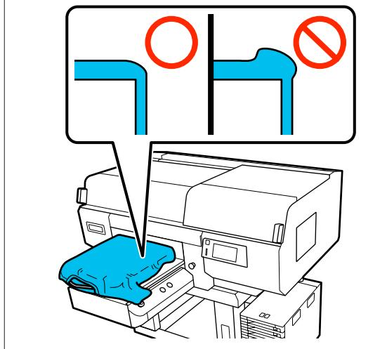
Для разглаживания поверхности печати используйте прилагаемый к принтеру разглаживатель. Футболка прикрепляется к противоскользящей прокладке печатного стола, которая сохраняет ровную поверхность печати и предотвращает сдвиг футболки во время печати.
