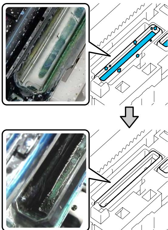
Скопление грязи по краям вызывает уменьшение силы всасывания. Если осталась грязь, смочите чистящую палочку чистящей жидкостью и повторите действия 7 и 8 для удаления грязи. Если в процессе очистки чистящая палочка загрязнилась, возмите новую.
