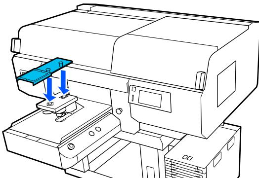
(2) Выровняйте фиксирующую ленту по выемке в верхней части печатного стола и плотно намотайте ее.
