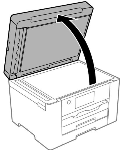
4. قم بتنظيف الجزء الموضح في الرسم التوضيحي.
