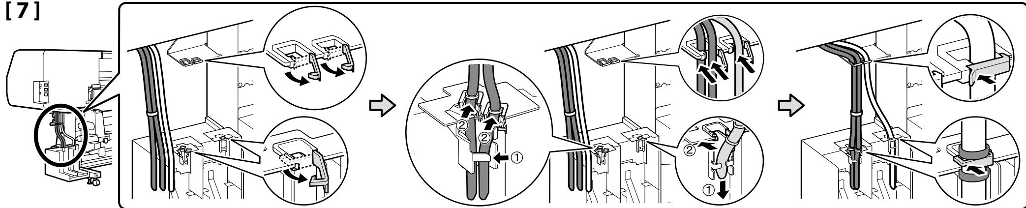
Następnie wyjmij następujące elementy z opakowania i zainstaluj je w odpowiedniej kolejności: Automatyczna Jednostka Nawijająca(Pobierająca) ① > Pręt napinający ② > Podajnik mediów ③.
