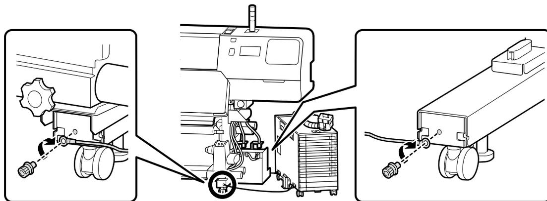
Kısıtlama telini yazıcı ayağının önüne ve arkasına vidalar kullanarak sabitlediğinizden emin olun. Mürekkep birimi kısıtlama teliyle sabitlenmediği takdirde, mürekkep birimi, mürekkep birimi bağlıyken hareket ettirilirse mürekkep tüpü hasar görebilir.
