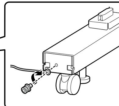
Sørg for at afsikre fastholdelsesledningen foran og bag på printerbenet med skruer. Hvis blækenheden ikke er afsikret med fastholdelsesledningen, kan blækrøret blive beskadiget, hvis blækenheden flyttes, mens blækenheden er tilsluttet.
