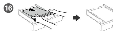
Coloque papel A4 no sentido da parte posterior do alimentador de papel com o lado a imprimir voltado para baixo e ajuste o guia da extremidade frontal ao papel.
