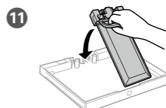
Encaixe a unidade de alimentação de tinta no tabuleiro da unidade de alimentação de tinta.
