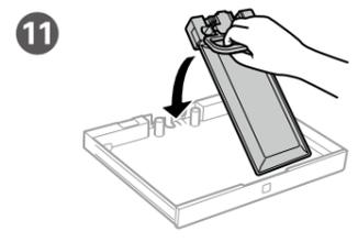
11 Encaixe a unidade de alimentação de tinta no tabuleiro da unidade de alimentação de tinta.
