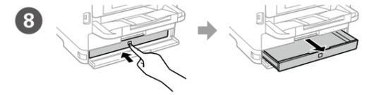
8 Pressione a unidade de alimentação de tinta e retire-a.
