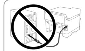
**Nie podłączaj kabla USB przed wyświetleniem się odpowiedniej instrukcji. Nie podłączaj kabla USB, nie będzie-li zysk. Ne csatlakoztassa az USB kábelt, amíg erre utasítást nem kap. Bez vyzvania nepripájajte USB kábel.**
