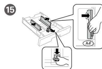
Ściśnij i przesuń prowadnice krawędzi.
