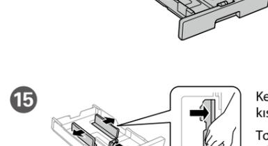
Smjestite jedinicu za dovod tinte u ladicu jedinice za dovod tinte. Монтирајте ја единицата со мастило во фиоката за единица со мастило. Postavite jedinicu za dovod mastila u ležište jedinice za dovod mastila.
