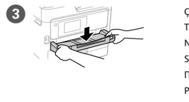
Çıkış tepsisini yerleştirin. Τοποθετήστε το δίσκο εξόδου. Namestite izhodni pladenj. Stavite izlaznu ladicu. Поставете ја излезната фиока. Postavite izlazno ležište.
