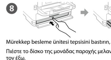
Mürekkep besleme ünitesini tepsisini bastırın, ardından çekerek çıkarın. Πιέστε το δίσκο της μονάδας παροχής μελανιού και, στη συνέχεια, τραβήξτε τον έξω. Pritisnite pladenj enote za dovajanje črnila in ga izvlcite. Pritisnite ladicu jedinice za dovod tinte i izvucite je van. Притиснете ја фиоката за единицата со мастило, а потоа извлекете ја. Pritisnite ležište jedinice za dovod mastila, a zatim ga izvucite.
