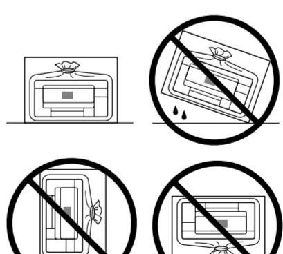
**! Uverite se da je bočica s mastilom uspravna kada pričvršćujete zatvarač. Odvojeno stavite štampač i bočicu u plastičnu vreću i držite štampač u horizontalnom položaju tokom transporta. U suprotnom, može doći do curenja mastila.**
