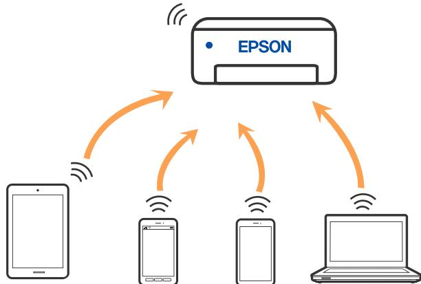
Принтерът може да се свърза чрез Wi-Fi или Ethernet и режим Wi-Fi Direct (обикновена точка за достъп) едновременно. Въпреки това, ако установите мрежова връзка в режим Wi-Fi Direct (обикновена точка за достъп), когато принтерът е свързан чрез Wi-Fi, Wi-Fi връзката ще бъде временно прекъсната.
