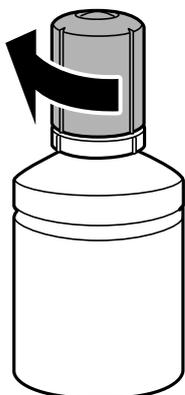
10. Cierre con firmeza la cubierta del tanque de tinta.
