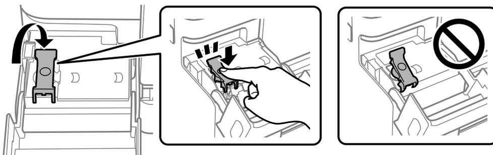
12. Cierre bien la cubierta del tanque de tinta.
