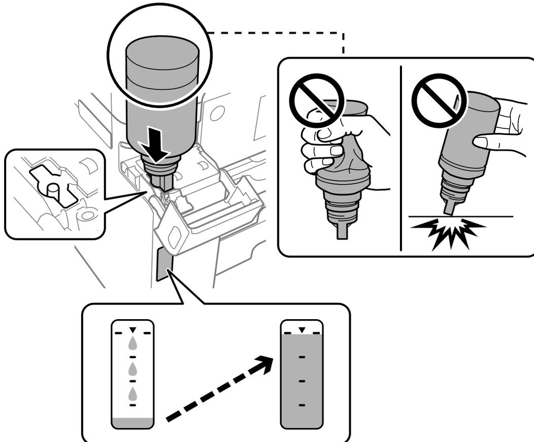
9. Cuando termine de rellenar la tinta, quite el bote de tinta y cierre bien la tapa del tanque de tinta.
