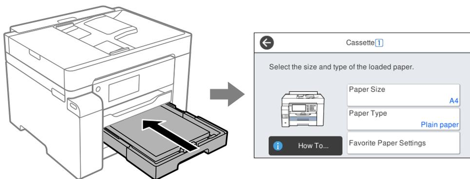
Si el tamaño y el tipo de papel mostrados son diferentes a los del papel cargado, seleccione el elemento que desee cambiar. Si los ajustes coinciden con el papel cargado, cierre la pantalla.
