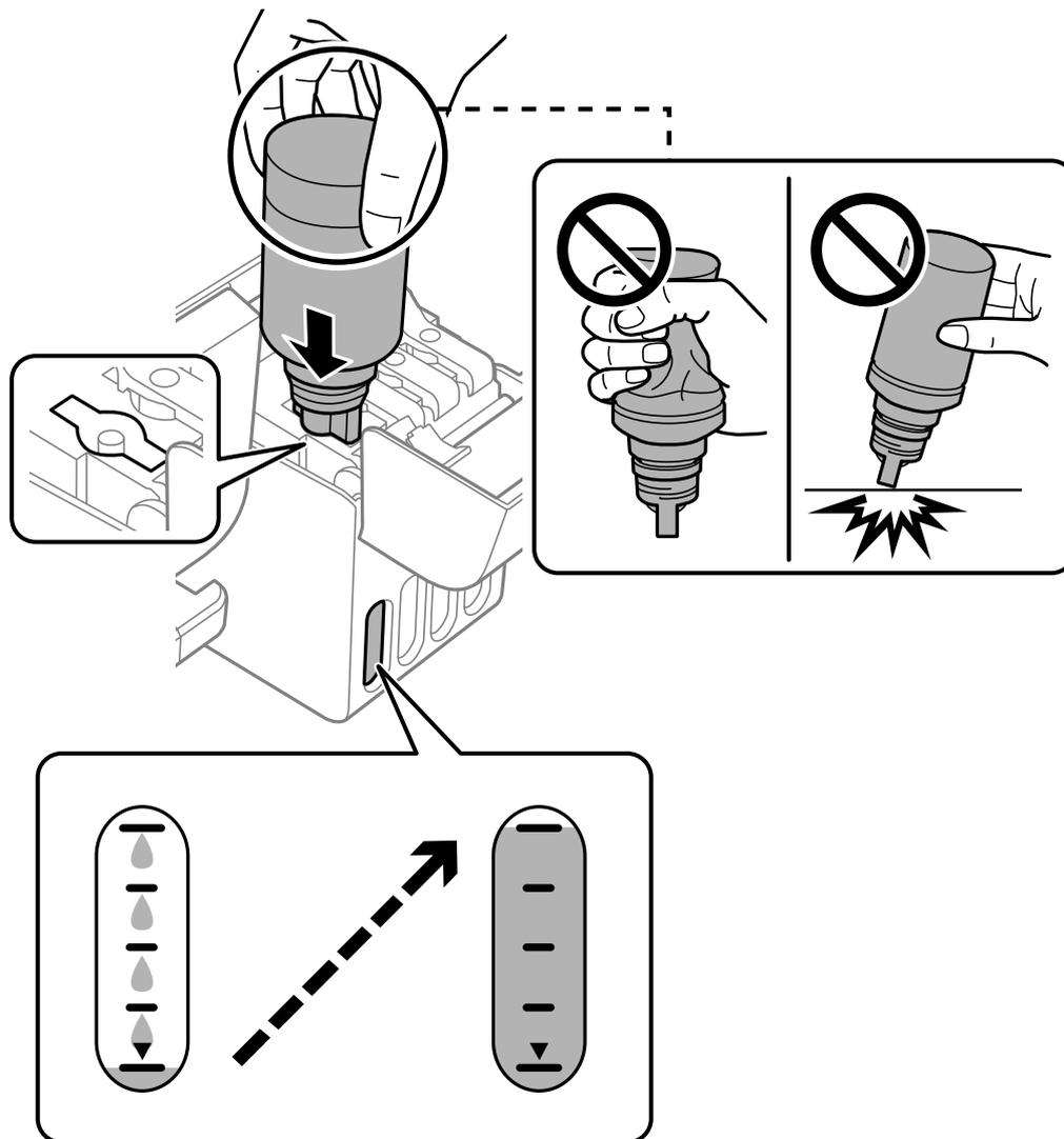
6. Quando tiver terminado de carregar a tinta, remova o frasco de tinta e a seguir, feche firmemente o tampão do depósito de tinta.
