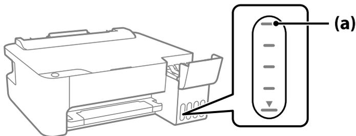
5. Alinee la parte superior del bote de tinta con el puerto de llenado y, a continuación, introdúzcalo recto en el puerto de llenado la tinta hasta que se detenga automáticamente en la línea superior.
