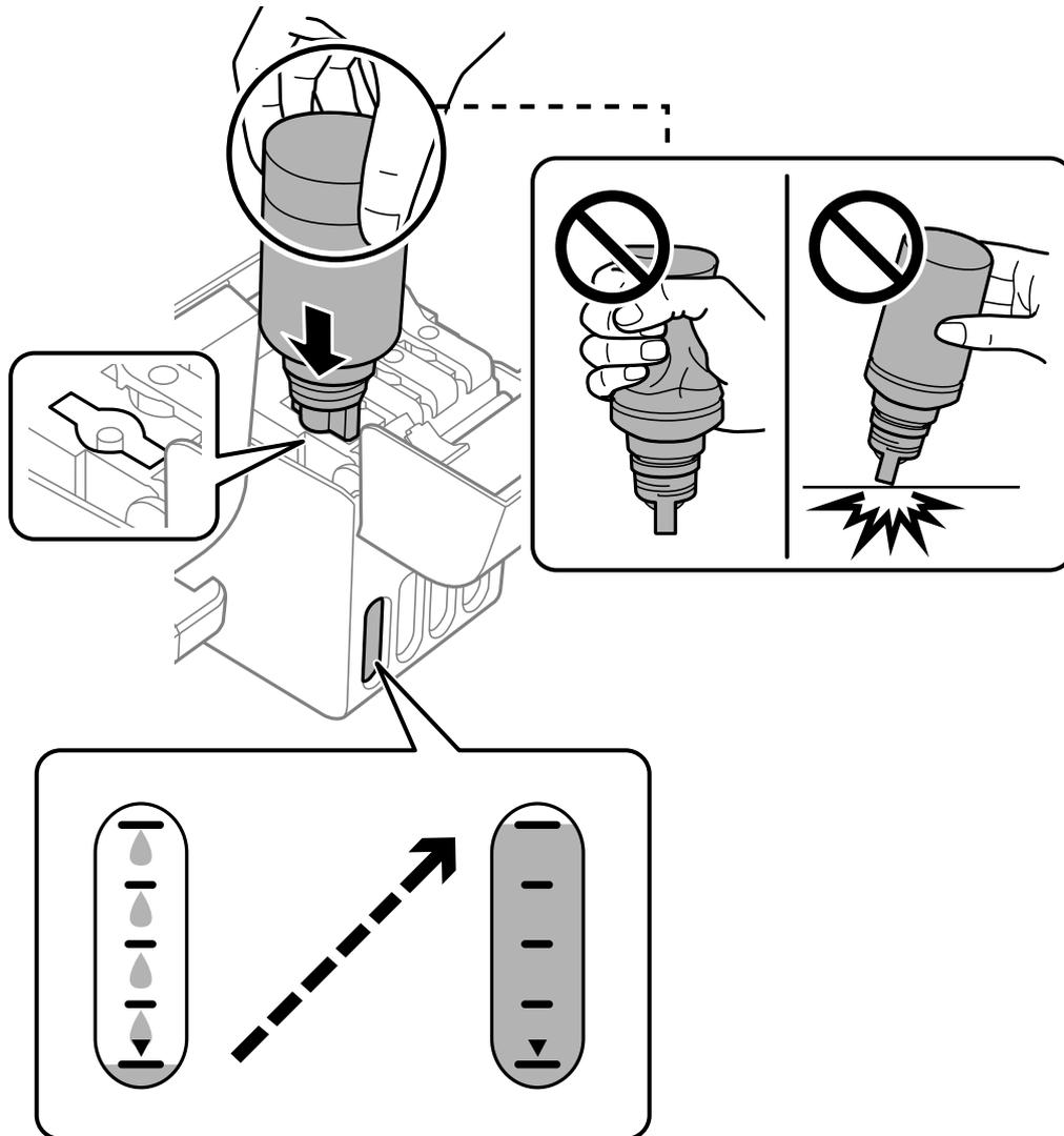
6. Cuando termine de rellenar la tinta, quite el bote de tinta y cierre bien la tapa del tanque de tinta.
