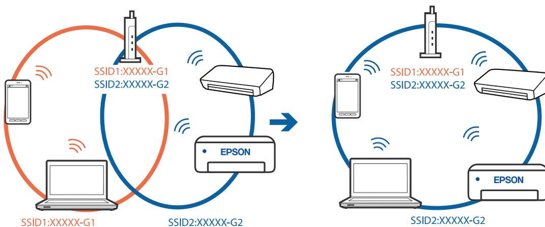
❑ Ejemplo de conexión a SSID con intervalos de frecuencias diferentes
