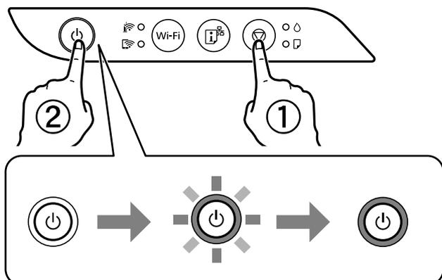
Se imprimirá el patrón del test de inyectores.
