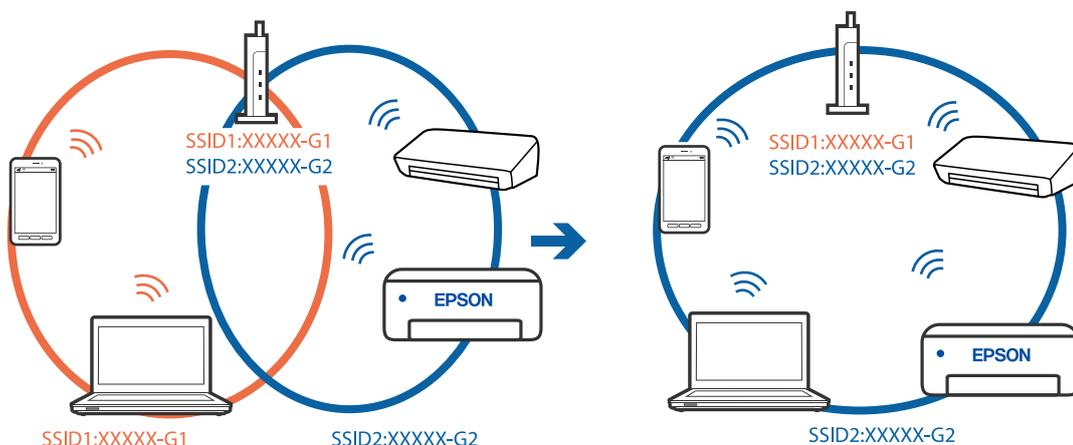
❑ Ejemplo de conexión a SSID con intervalos de frecuencias diferentes
