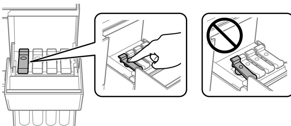
6. Chiudere saldamente il coperchio del serbatoio dell'inchiostro.
