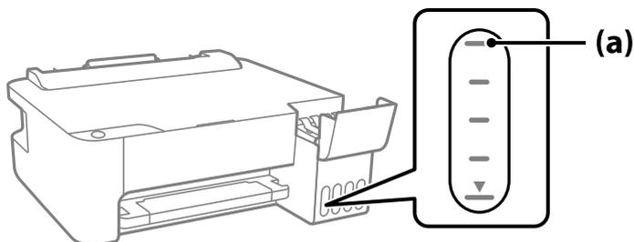
5. Allineare la parte superiore della bottiglia di inchiostro con la porta per il riempimento, quindi inserirla direttamente nella porta per versare l'inchiostro. Il flusso si interrompe automaticamente una volta raggiunta la linea superiore.
