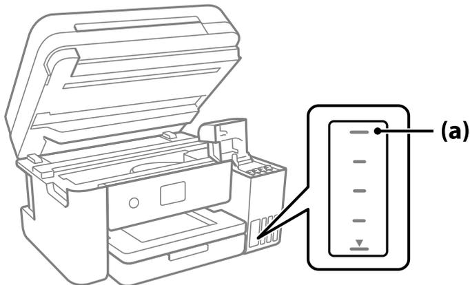
7. Alinhe a parte superior do frasco de tinta com a porta superior, e a seguir coloque-a na porta para encher com tinta até parar automaticamente na linha superior.
