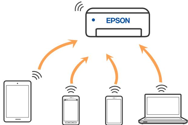
يمكن توصيل الطابعة عن طريق شبكة Wi-Fi أو إيثرنت، واتصال Wi-Fi Direct (نقطة الوصول البسيط) في وقت واحد. وبالرغم من ذلك، إذا بدأت اتصال الشبكة في وضع اتصال Wi-Fi Direct (نقطة الوصول البسيط) عندما تكون الطابعة متصلة عن طريق شبكة Wi-Fi، فسيتم قطع الاتصال بشبكة Wi-Fi بشكل مؤقت.
