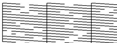
Se faltarem partes do padrão de verificação, pressione **M**, e a seguir realize a Limpeza cab. impressão.
