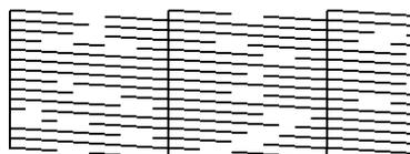
При отсутствии каких-либо частей шаблона проверки нажмите **Неудовл.**, затем выполните процедуру Очистка печ. головки.
