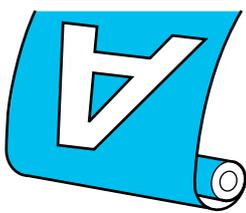
При наматывании бумаги печатной стороной внутрь поверхность печати будет на внутренней стороне рулона. В большинстве случаев рекомендуется прием стороной печати внутрь.
