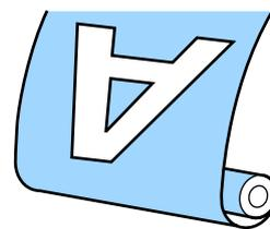
Bei der Aufnahme mit der bedruckten Seite innen wird die bedruckte Oberfläche auf der Innenseite der Rolle platziert. In den meisten Fällen wird „Bedruckte Seite innen“ empfohlen.
