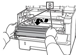
**7** Coloque a unidade de manutenção B na horizontal num local limpo.
