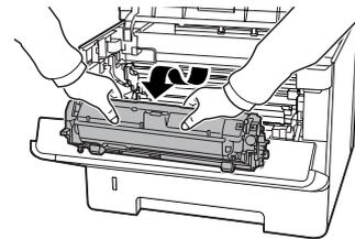
**5** Coloque a unidade de manutenção A na horizontal num local limpo.
