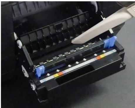
2 امسح أي أتربة، مثل غبار الورق، على طاولة ماكينة الطباعة (المنطقة الموضحة باللون الأزرق في الرسم التوضيحي أدناه) باستخدام ممسحة قطنية متوفرة تجارياً.
