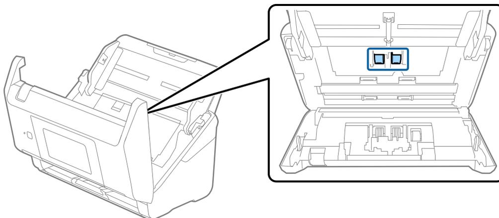
9. Obrišite prašinu ili nečistoće na prijemnom valjku pomoću originalnog Epsonovog pribora za čišćenje ili meke, vlažne krpe.
