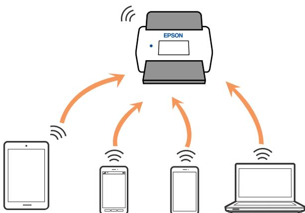
Skener se može povezati pomoću Wi-Fi ili Ethernet veze i veze Wi-Fi Direct (režim jednostavne pristupne tačke) istovremeno. Međutim, ako pokrenete mrežno povezivanje u vezi Wi-Fi Direct (režim jednostavne pristupne tačke) kada je skener povezan putem Wi-Fi veze, Wi-Fi veza se privremeno prekida.
