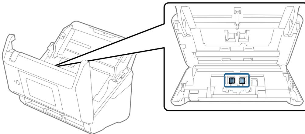
7. Obrišite prašinu ili nečistoće na valjku za razdvajanje pomoću originalnog Epsonovog pribora za čišćenje ili meke, vlažne krpe.
