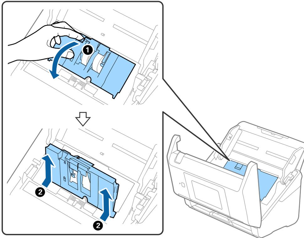
5. Pritisnite deo za učvršćivanje osovine valjka, a zatim gurnite i izvadite montirane prijemne valjke.
