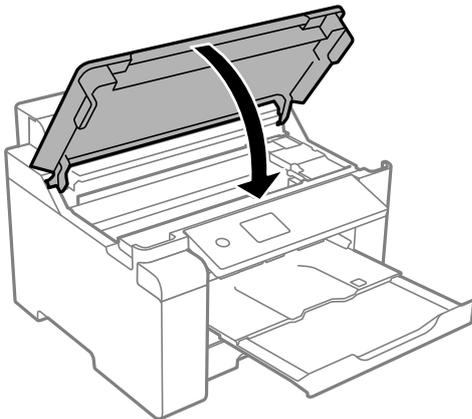
9. Assurez-vous de bien installer le capuchon du réservoir d'encre sur le réservoir.
