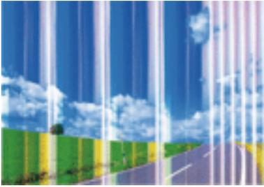
Басып шығару механизмінің шүмектері бітелуі мүмкін. Басып шығару механизмінің шүмектері бітелгенін не бітелмегенін тексеру үшін шүмекті тексеріңіз. Басып шығару механизмі шүмектерінің бітелген болса, басып шығару механизмін тазалаңыз.
