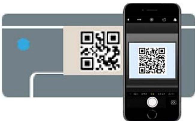
iOS 11 немесе кейінгі нұсқасына арналған «Камера» қолданбасын пайдаланыңыз. iOS 10 немесе бұрынғы нұсқасына арналған «Камера» қолданбасы арқылы принтерге қосыла алмайсыз. QR кодтарын сканерлеуге арналған қолданба арқылы да қосыла алмайсыз. Егер жалғау мүмкін болмаса, ◀ түймесін басыңыз. Қосылуға қатысты мәліметтер алу үшін төмендегі «Қатысты ақпарат» бөлімін қараңыз.
