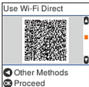
7. No seu iPhone, iPad, ou iPod touch, inicie a aplicação da câmara fotográfica, a seguir aponte a câmara para o código QR exibido no painel de controlo da impressora no modo FOTOGRAFIA.
