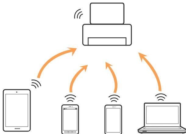
Μπορείτε να συνδέσετε ταυτόχρονα τον εκτυπωτή μέσω Wi-Fi ή Ethernet και της λειτουργίας Wi-Fi Direct (Simple AP). Ωστόσο, αν ξεκινήσετε μια σύνδεση δικτύου σε λειτουργία Wi-Fi Direct (Simple AP) όταν ο εκτυπωτής είναι συνδεδεμένος μέσω Wi-Fi, το Wi-Fi αποσυνδέεται προσωρινά.
