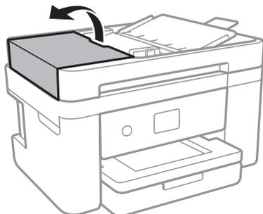
2. Nettoyez le rouleau et l'intérieur du chargeur à l'aide d'un chiffon doux et humide.
