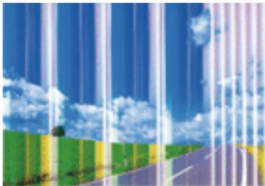
Il est possible que les buses de la tête d'impression soient obstruées. Procédez à une vérification des buses pour vérifier si les buses de la tête d'impression sont obstruées. Nettoyez la tête d'impression si des buses de la tête d'impression sont obstruées.
