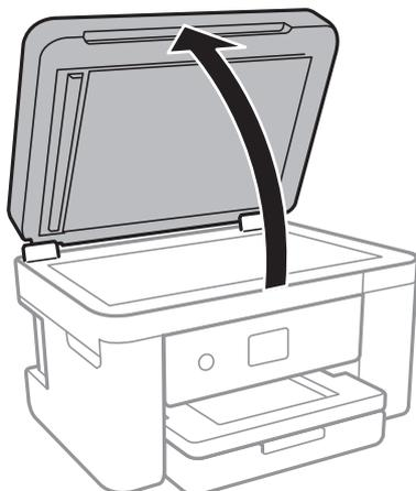
2. Nettoyez la surface de la vitre du scanner à l'aide d'un chiffon doux, sec et propre.
