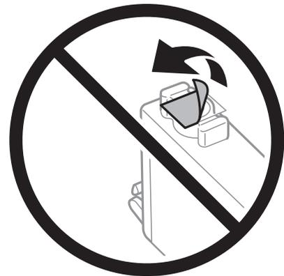
❑ لا تلمس الأجزاء الموضحة في الرسم التوضيحي. فقد يحول ذلك دون التشغيل والطباعة بصورة طبيعية.
