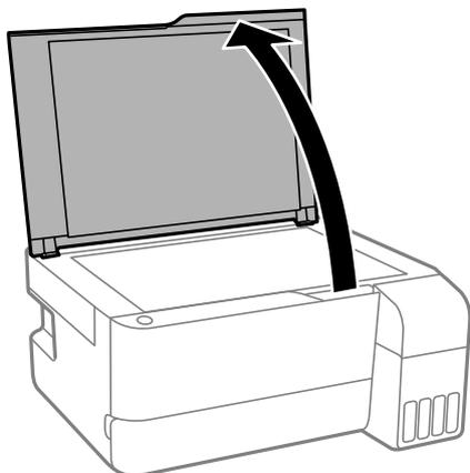
2. Rimuovere eventuali macchie o polvere sulla superficie del vetro dello scanner utilizzando un panno asciutto, morbido e pulito.
