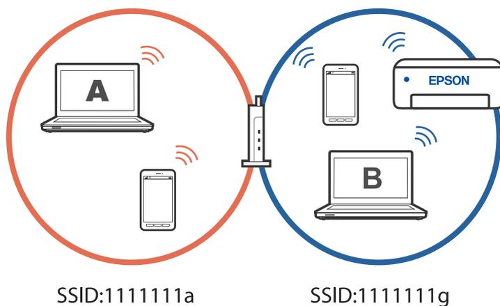
Para prevenir que esto ocurra, cuando quiera configurar una impresora conectada a la red desde un segundo ordenador, inicie el instalador del ordenador conectado a la misma red que la impresora. Si la impresora se encuentra en la misma red, la impresora no se reconfigurará para la red y la configurará lista para usar.
