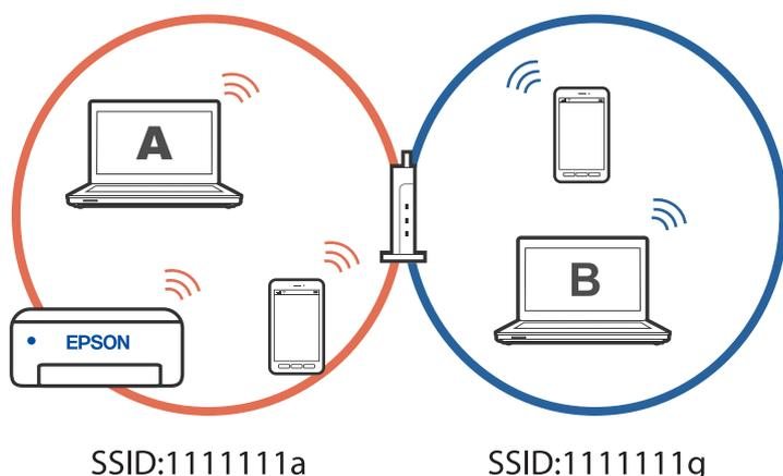
Además, si empieza a configurar la impresora desde el ordenador B en la configuración mostrada a continuación, la impresora se configura en la red del ordenador B permitiendo a este imprimir, pero no al ordenador A.
