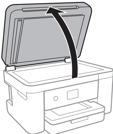
2. Utilice un paño seco, suave y limpio para limpiar la superficie del cristal del escáner.
