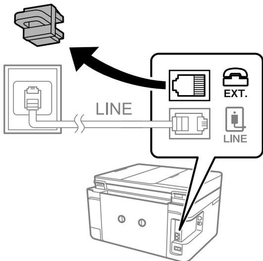
2. Conecte el teléfono y el puerto EXT. con un cable telefónico.
