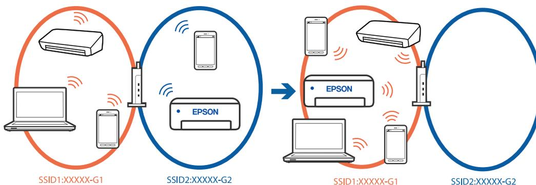
❑ Ejemplo de conexión a SSID con intervalos de frecuencias diferentes
