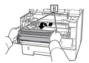
Posizionare l'unità di manutenzione B orizzontalmente in una posizione pulita.
