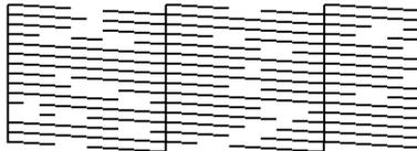
Wenn das Düsenprüfmuster Lücken aufweist, drücken Sie [X] und führen dann eine Kopf reinigen durch.
