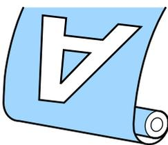
Lors de l'enroulement avec la face imprimée vers l'intérieur, la surface imprimée se trouve sur la partie intérieure du rouleau.
