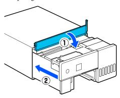
Stellen Sie den Drucker hochkant auf, wie in der Abbildung gezeigt (die Vorseite des Druckers befindet sich unten).
