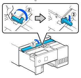
Schließen Sie die Innenabdeckung, setzen Sie das Innere des Druckers wieder in der ursprünglichen Position ein.
