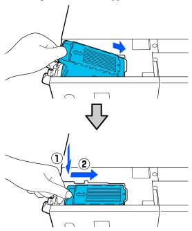
9 Schließen Sie die Abdeckung des Wartungskastenabdeckung.
