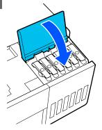
Schließen Sie die Innenabdeckung, setzen Sie das Innere des Druckers wieder in der ursprünglichen Position ein und schließen Sie dann die Vorderabdeckung.
