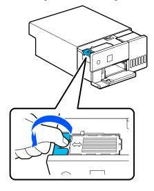
Entfernen Sie den Wartungskasten.
