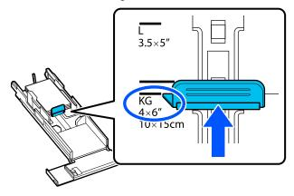
Schieben Sie das Papier an die Vorderseite der Kantenführung.
