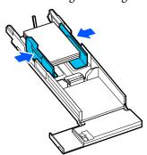
Heben Sie den die vordere Kantenführung an.
