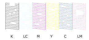
Wenn ein Teil des Testmusters fehlt, sind die Druckkopfdüsen verstopft. Der Druckkopf muss gereinigt werden.
