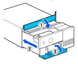
Installieren Sie die hintere Abdeckung.
