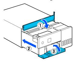
11 Installieren Sie die hintere Abdeckung.
