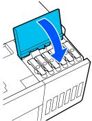
Setzen Sie das Innere des Druckers wieder in der ursprünglichen Position ein und schließen Sie dann die Vorderabdeckung.
