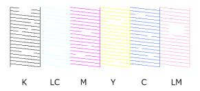
Wenn ein Teil des Testmusters fehlt, sind die Druckkopfdüsen verstopft. Der Druckkopf muss gereinigt werden. A "Methoden der Druckkopfreinigung" auf Seite 78
