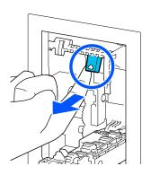
(3) Halten Sie den Hebel in Schritt 2 angehoben, während Sie den Rollenaufbausatz anheben. Die Spitzen der Vorsprünge müssen aus den Löchern im Rollenaufbausatz herausragen, wie in der Abbildung gezeigt, und nehmen Sie dann Ihren Finger vom Hebel der Rollenfeststellhebel.
