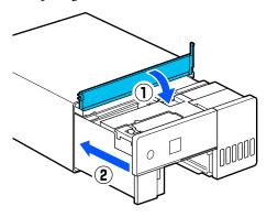
16 Installieren Sie die hintere Abdeckung.
