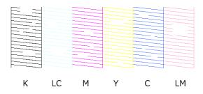
Si falta parte del patrón, quiere decir que los inyectores de del cabezal de impresión están obstruidos. Es necesario limpiar el cabezal de impresión.
