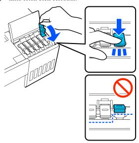
Cierre bien la cubierta de tanques de tinta.
