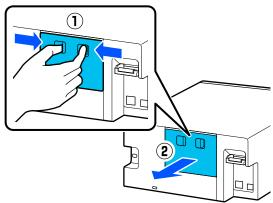
Coloque la mano como se muestra en la imagen y tire del interior de la impresora hasta que pare.
