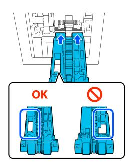
(2) Como se muestra en la ilustración, levante la palanca de bloqueo del rodillo hacia usted.
