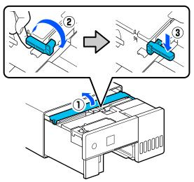
Cierre la cubierta interna y vuelva a poner el interior de la impresora en su posición original.
