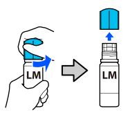
Alinee el bote con la boquilla de la tinta e introdúzcalo. Luego, espere a que la tinta se detenga por sí misma en la línea superior de llenado (a).
