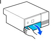
Coloque la mano como se muestra en la imagen y tire del interior de la impresora hasta que pare.
