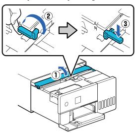
Use cinta adhesiva para fijar el cabezal de impresión y que no se mueva.
