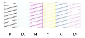
Si falta parte del patrón, quiere decir que los inyectores de del cabezal de impresión están obstruidos. Es necesario limpiar el cabezal de impresión.
