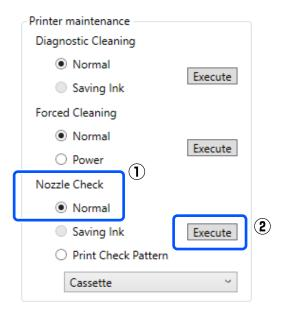
Se ejecuta el test de inyectores.
