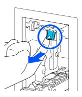
(3) Mantenga levantada la palanca del paso 2 mientras levanta el kit de montaje del rodillo de forma que las puntas de las protuberancias salgan por fuera de los orificios del kit de montaje del rodillo, como se muestra en la ilustración, y luego suelte el dedo de la palanca de bloqueo del rodillo.
