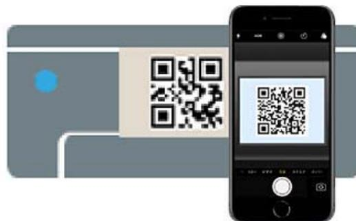
Используйте приложение «Камера» для iOS 11 или более поздней версии. К принтеру нельзя подключиться с помощью приложения «Камера» для iOS 10 или более ранней версии. Кроме того, приложения для сканирования кодов также нельзя использовать для подключения к принтеру. Если подключиться не удастся, нажмите кнопку ◀. Сведения о подключении см. ниже в разделе «Дополнительные сведения».
