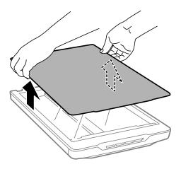
2. Coloque o documento com a face impressa virada para baixo no vidro do scanner.
