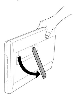
3. Incline o scanner até que o suporte toque na superfície plana.
